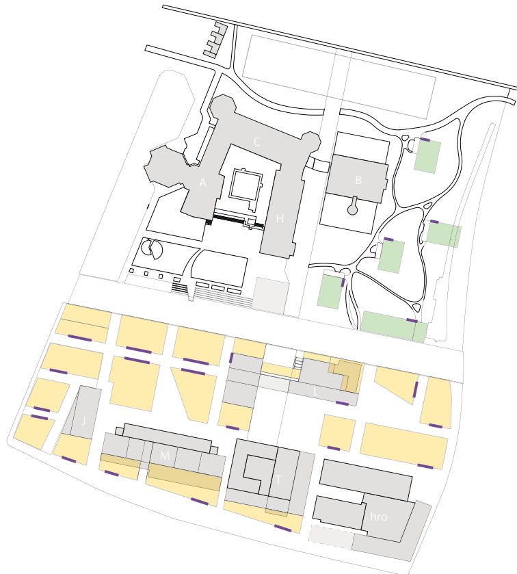
Situering expeditie per gebouw. Expeditie- en containerruimten nemen max. 33% van de gevellengte in beslag
